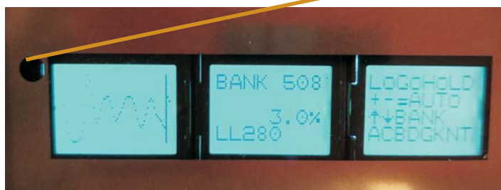
Abbildung 7. AK30 Display mit Trendkurve und detaillierten Informationen, in Blau im BANKEN-Modus. Das Menü-System ist gleichzeitig verfügbar.
