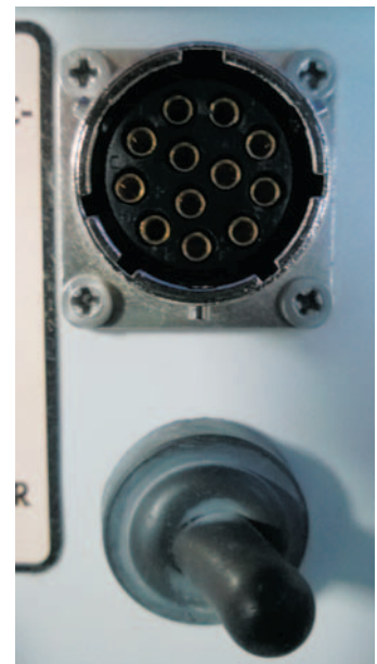
Kuva 2. Virtakytkin sekä kaapeliliitin mallille AK40, 12-napainen ITT Cannon
