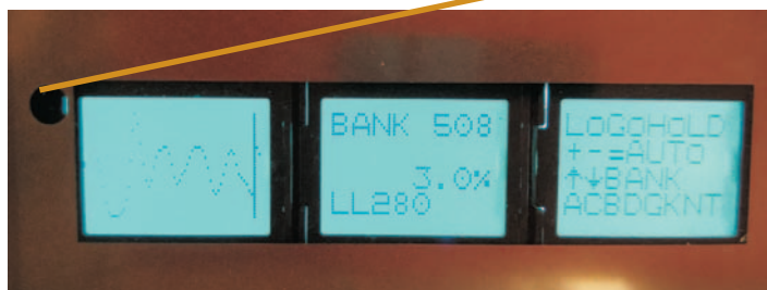
Kuva 7. AK30/MK30R näyttö jossa on trendikäyrä sekä muuta tietoa mittauksesta, BANKS-moodi, sininen väri. Valikko on käytettävissä samaan aikaan.
