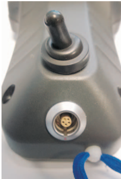
Kuva 1. Virtakytkin ja latauksen kaapelin liitin AK30-mallille, LEMO OK liitin
