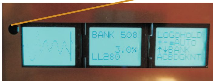
Abbildung 7. AK30/MK30R Display mit Trendkurve und detaillierten Informationen, in Blau im BANKEN-Modus. Das Menü-System ist gleichzeitig verfügbar.
